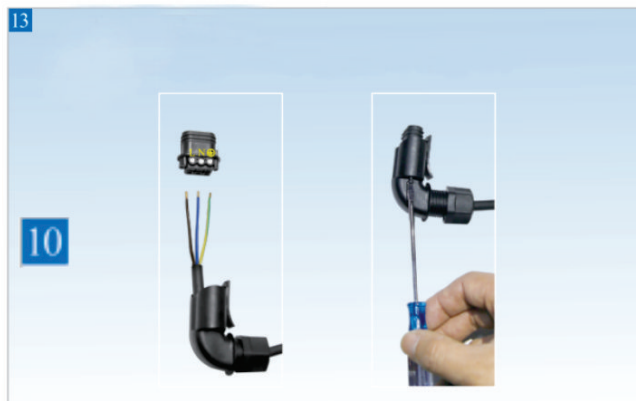
۱۰- نصب صحیح سیم های برق موتور به سوکت
