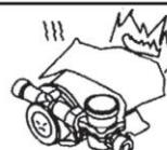
5. از نصب و یا قراردادن هرگونه پوشش و یا کاوری به طور مستقیم بر روی پمپ، که در خنک شدن پمپ خلی ایجاد می کند جلوگیری کنید، این کار باعث افزایش دمای موتور و حتی آتش سوزی خواهد شد.
