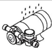
3. از نصب پمپ در محیط های مرطوب و یا احتمال پاشش آب بر روی آن مانند حمام و سرویس بهداشتی پرهیز کنید. نصب پمپ در این مکان ها می تواند باعث شوک و برق گرفتگی شود.
